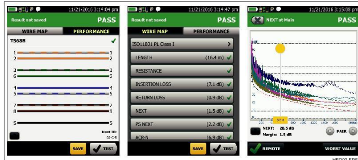
Kuva 5. Esimerkkejä kierretyn parikaapelin mittaustuloksista
