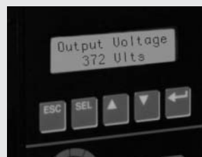
Kuva 2. Lähtöjännitelukema, kun alipäästösuodatin on käytössä.
