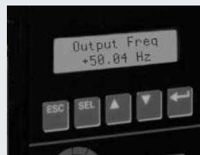
Kuva 4. Lähtötaajuus (moottorin nopeus), kun alipäästösuodatin on käytössä.
