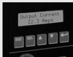
Kuva 6. Lähtövirtalukema, kun alipäästösuodatin on käytössä.
