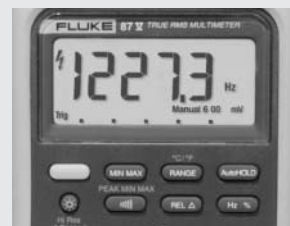
Kuva 3. Lähtötaajuus (moottorin nopeus), kun alipäästösuodatin ei ole käytössä.
