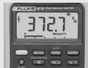
Kuva 2. Lähtöjännitelukema, kun alipäästösuodatin on käytössä.
