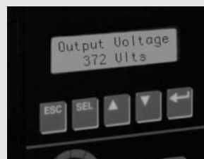
Kuva 1. Lähtöjännitelukema, kun alipäästösuodatin ei ole käytössä.
