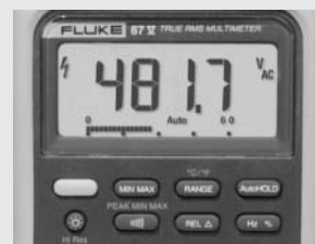
Kuva 1. Lähtöjännitelukema, kun alipäästösuodatin ei ole käytössä.
